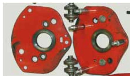
Flasques déformés >> Risque de blocage de l'appareil
