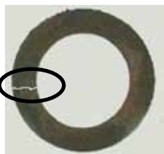
Garnitures de frein usées >> Mauvaise retenue de la charge
