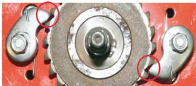
Usure des cliquets >> Mauvais fonctionnement de l'appareil
