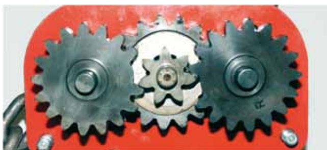
Dents de pignon cassées >> Libération brutale de la charge
