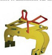
Pinces pour levage de charge à faces parallèles sans marquage. Fonctionnement manuel, semi-automatique ou automatique. Les mors sont adaptés à la géométrie de la charge. Peut être également utilisée pour des charges cylindriques. Conception selon cahier des charges. Sans soudures portantes. Capacités et dimensions sur mesure.
