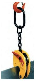
Pinces dotées d'un système de sécurité par ressort permettant un contact permanent de la came sur la pièce à lever, même lors de la dépose de celle-ci. Le levier de réarmement non dépassant permet l'utilisation à même le sol. La chaîne permet le basculement et facilite la mise en place de la pince. La came crantée ne marque qu'une face de la charge.
