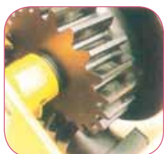
Sécurité absolue : vis sans fin et frein automatique.
