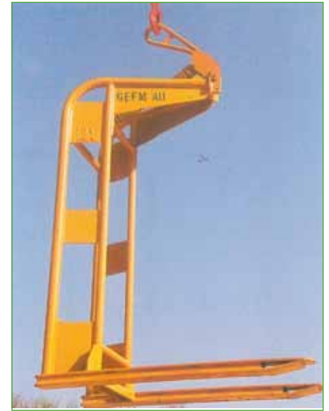
GEFM AU : GRIFFE EQUILIBREE A FOURCHES MINCES EQUIPEE D'UN DISPOSITIF D'AUTOEQUILIBRAGE
